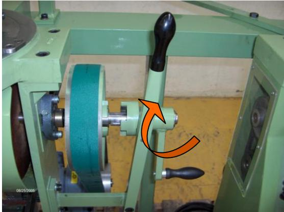
Le fil en place sur la tête de tricotage, il faut mettre la tête de tricotage en marche manuellement.
