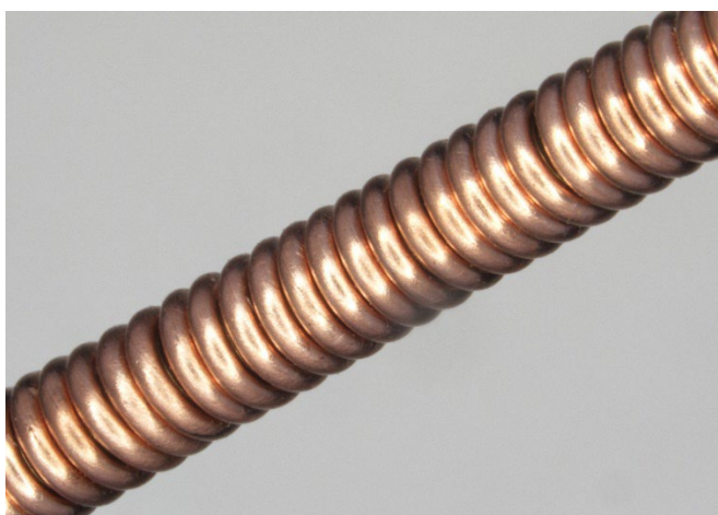
Abb. 1: Verdrehter verkupferter Draht mit Ø 0.60 mm
